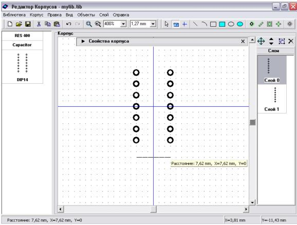
Измените форму первого вывода на "Прямоугольник": щелчок правой кнопкой по выводу, выберите "Свойства" в подменю, затем "Прямоугольник" в поле "Форма" и нажмите "ОК". Измените шаг сетки на "0.635мм" и создайте шелкографию для "DIP14", используя линии и дугу:
