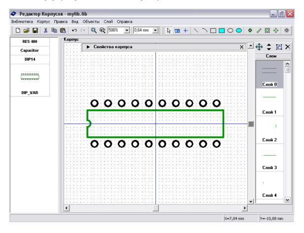
Разверните панель свойств корпуса используя кнопку в ее левом верхнем углу и попробуйте изменить "Количество 2" например на "16". Вы можете увидеть, что кроме количества выводов изменилась шелкография, т.о. Вы можете получить любой DIP корпус с расстоянием между линиями выводов 7.62 мм, изменяя всего один параметр.
