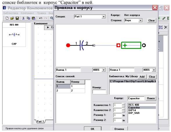
Заметьте, что Вы можете изменить расстояние между выводами для корпуса, т.к. Вы указали этот параметр изменяемым в Редакторе корпусов. Но после конвертирования схемотехники в РСВ все изменяемые параметры будут заблокированы и размещенный корпус будет иметь фиксированное количество выводов и расстояние между ними.
