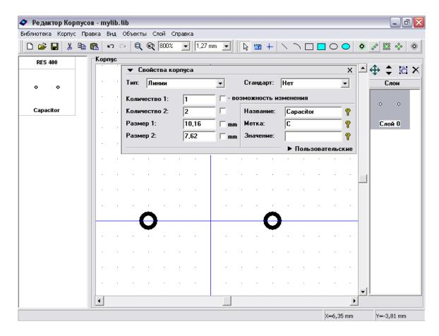
Вы можете использовать различные типы ("Линии" и т.д.) для создания корпусов с фиксированным количеством выводов и размерами (вероятно 95-100% Ваших корпусов будут неизменяемыми). Тогда просто уберите "возможность изменения".
