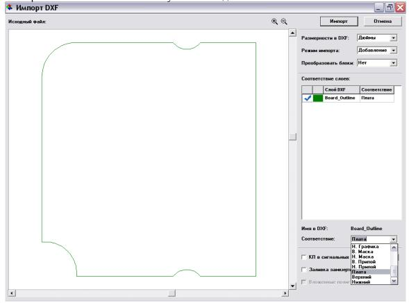
Кстати, вы можете заливать замкнутые области и вырезать отверстия в них, если необходимо (обычно чертежи в DXF сделаны без заливки, только границы фигур). Заливка вложенных полигонов работает только для сигнальных слоев, паяльной маски и пасты.
