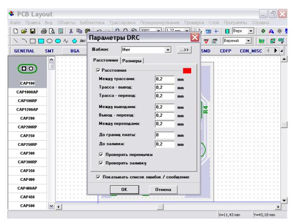
В окне правил проверки Вы можете задать допустимые зазоры между различными типами объектов. Выберите "Проверять заливку" и нажмите "ОК" для применения изменений и закрытия окна.
