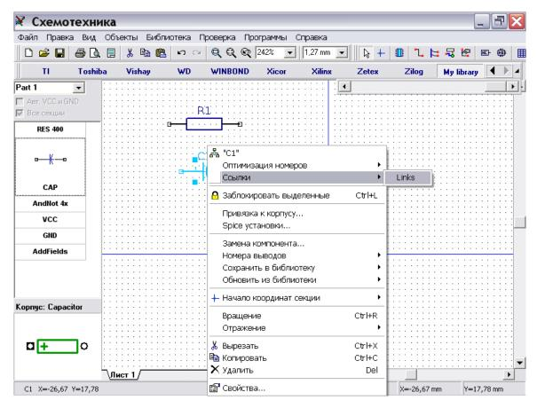
Вы можете также отображать дополнительные поля для нанесения надписей компонентов через "Вид / Надписи компонентов / Основная(Дополнительная) / Пользовательская" или изменить через окно свойств компонента (щелкните правой кнопки по компоненту и выберите "Свойства").
