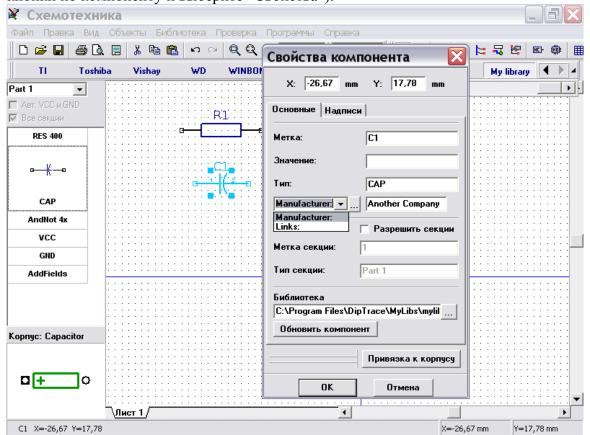
Выберите многосекционный компонент из списка компонентов. Вы создали компонент, с несколькими однотипными секциями и секцией питания. Все однотипные секции могут быть размещены на схеме одновременно или по отдельности. Для изменения режима установки многосекционных компонентов выберите "Вид / Группировка секций из главного меню".
