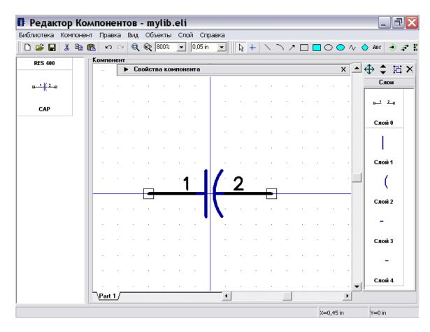
Следующий шаг – подключение корпуса к конденсатору. Выберите "Компонент / Привязка к корпусу" в главном меню, затем выберите Вашу библиотеку корпусов в
