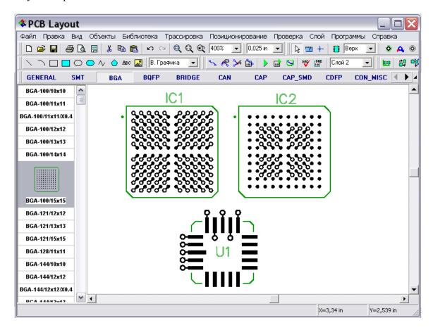
Мы видим, что у первого корпуса все выводы соединены с переходными отверстиями, у второго корпуса первые два внешних ряда выводов без переходов (они должны быть разведены в верхнем слое), а последующие ряды выводов соединяются с переходами по два ряда на каждый слой.
