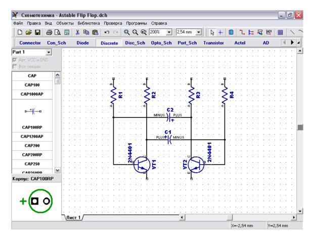
Выберите в списке компонентов в правой части окна компонент LED и разместите два компонента на Вашу схему. Затем измените метку на "LED1" и "LED2", поверните эти символы, выбрав их и нажав "R" или "Пробел" три раза и соедините с транзисторами:
