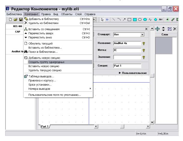
Теперь Вы увидите следующие секции: Part 1 (1), Part 1 (2), Part 1 (3) and Part 1 (4) в нижнем левом углу окна. Все однотипные секции имеют одинаковое имя. Вы можете изменить его, например на "AN".
