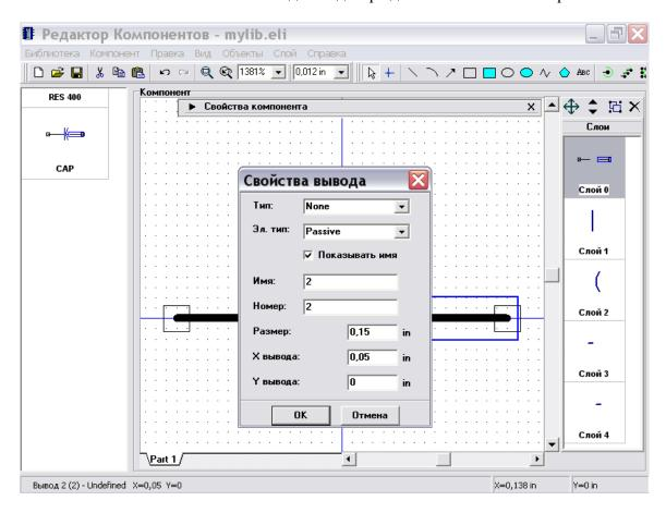
Обратите внимание, что все создаваемые выводы изначально имеют "Undefined" электрический тип, поэтому Вы можете изменить его используя диалог свойств вывода или таблицу выводов (см. ниже). Электрический тип вывода используется для проверки связей (ERC) в Схемотехнике. Тип вывода используется для изменения графики вывода, Вы можете попробовать различные типы и посмотреть изменения.
