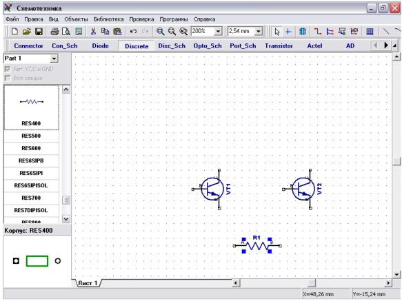
Нам нужно 4 резистора для нашей схемы. Вы можете их просто разместить из панели компонентов в левой части окна таким же образом, как мы разместили транзисторы VT1 и VT2, но мы используем другой метод. Выделите резистор как на рисунке выше и скопируйте его три раза. Это можно сделать двумя способами:
