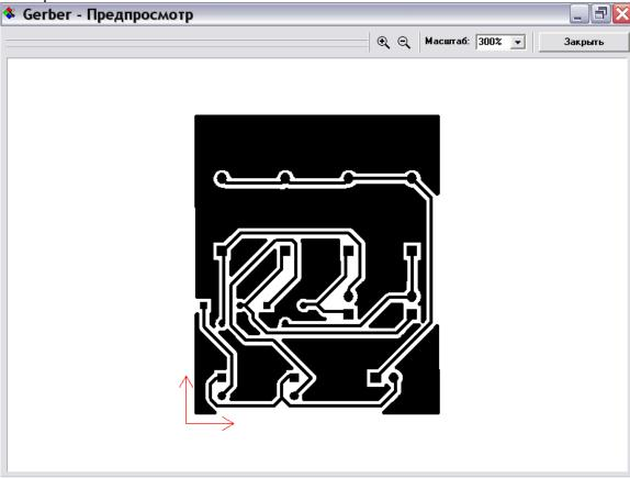
Смещение начала координат при экспорте DXF, Gerber, N/C drill и "Pick and Place" это положение вашей платы относительно нулевой точки. Также Вы можете использовать начало координат проекта, установив это в соответствующем поле в окне импорта.
