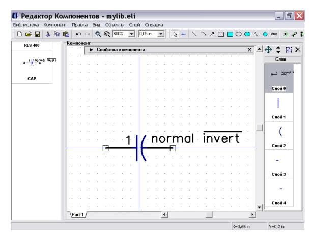
Скорее всего, нет необходимости отображать имя вывода для таких компонентов как конденсатор и, возможно, Вы хотите отобразить номер вывода. Заметьте, что Вы можете задать общие установки для отображения номеров выводов в программе Схемотехника, тогда все компоненты будут иместь установки по умолчанию, но Вы также можете задать отличные установки для отображения нумерации выводов для каждой секции в Редакторе Компонентов.
