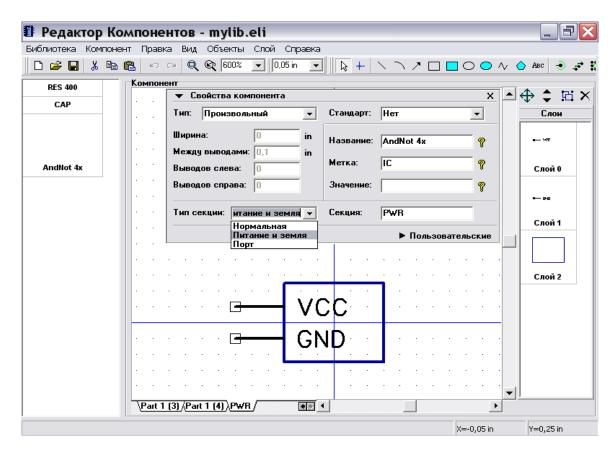
Выберите "Компонент / Таблица выводов" в главном меню, затем измените имена выводов на "VCC" и "GND", номера выводов на "14" и "7", электрический тип на "Power" и установите "Показывать имя" для обоих выводов. Заметьте, что параметры "Тип", "Показывать имя" и "Размер" можно изменять для нескольких выводов одновременно.
