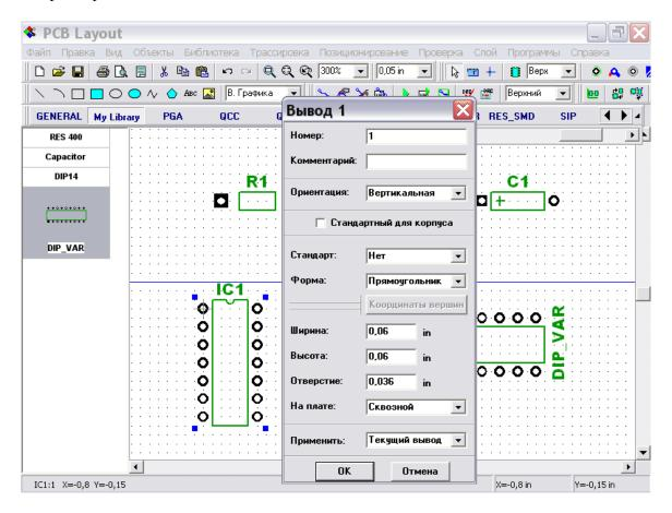
DIP14 корпус стандартный. Заметьте, что если Вы зададите начало координат корпуса, отличное от симметричного положения, оно будет показываться при установке корпуса (или при конвертировании схемы в плату). Также Вы можете легко отображать или скрывать начало координат корпуса для всех выбранных корпусов: щелкните правой кнопкой по одному из них и выберите "Начало координат корпуса" в подменю.
