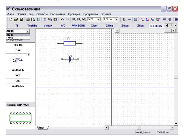
Заметьте, что активная секция и количество секций отображается в списке компонентов. Выберите "AN (4)" и попробуйте разместить несколько символов в области построения. Программа автоматически выбирает секцию из группы секций и размещает секцию питания для компонента.
