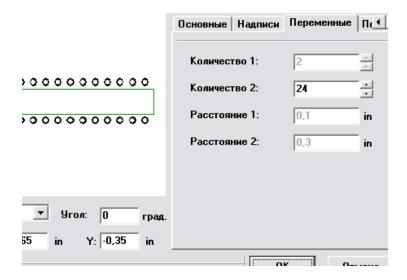
Аналогичную операцию Вы можете повторить с расстоянием между выводами конденсатора. Пожалуйста, будьте внимательны, когда создаете, размещаете и изменяете размеры корпусов с изменяемыми параметрами.
