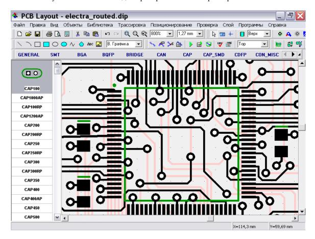
Также для завершения Вашего проекта выберите все, щелкните по одной из заливок в экранных слоях и выберите "Обновить" для заполнения заливки. Также запустите проверку целостности сетей для проверки, все ли сети на плати правильно соединены.
