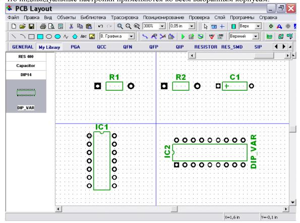
Мы забыли изменить форму первого вывода на прямоугольник для корпуса DIP14. Мы сделаем это в PCB Layout: подведите курсор к первому выводу корпуса DIP14, щелкните правой кнопкой, выберите "Свойства вывода". В диалоговом окне снимите отметку "Стандартный для корпуса", измените форму на "Прямоугольник" и щелкните "ОК". Заметьте, что Вы можете изменить настройки по умолчанию для выводов: щелкните правой кнопкой по корпусу и выберите "Параметры выводов" в подменю.
