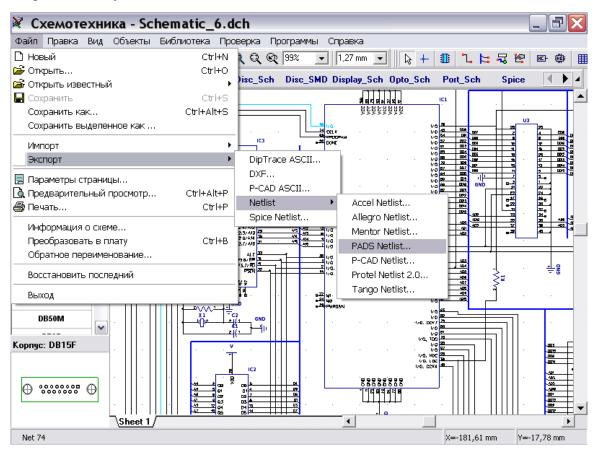
Рассмотрим на примере процесс импорта нетлиста в Tango-формате, созданного программой PCAD. Для этого откроем новый документ в PCB Layout и выберем File \ Import \ Netlist \ Tango, а затем укажем имя файла и путь: tango\_1.net в папке
