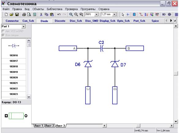
DipTrace поддерживает много-уровневую иерархию, т.е. Вы можете установить иерархический блок внутри другого блока. Перейдите на второй лист, выберите «Объекты/Иерархия/Добавить блок» или нажмите кнопку с надписью «НВ» на панели объектов. В списке возможных блоков выберите «Лист3» и установите два блока на второй лист.
