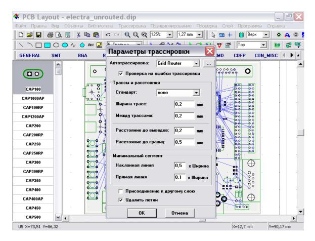
Ширина трасс для сетей должна быть не больше, чем размер выводов, которые соединяются этими трассами. Однако, в некоторых случаях авттрассировщик не может полностью развести все сети. Также проверте свойства межслойных переходов. Применим переходы с диаметром 1мм и отверстием 0.5мм.
