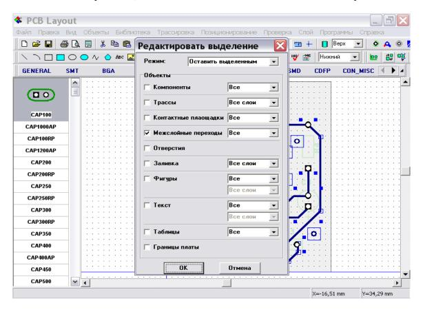
Щелкните ОК и только неподключенные переходные отверстия будут выделены. Следущим шагом, соединим их к некоторй сети. Обычно это необходимо для того, чтобы объединить сеть «земли» с заливкой или экранным слоем. Щелкните правой кнопкой по одному из выбранных переходных отверстий, когда он будет подсвечен красным цветом, и выберите «Добавить в сеть / Выбранные переходы».
