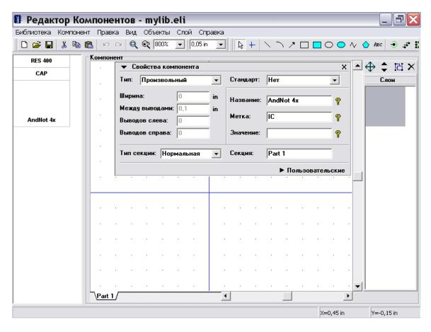
Следующий шаг — создание секций компонента. DipTrace позволяет создавать отдельные секции и группы секций (похожие секции). Все секции в группе секций имеют одинаковое количество выводов, шелкографию и т.д., кроме нумерации выводов. Также секции могут иметь различный тип: Нормальный, Питание и Земля и Порт. Секции питания и выводы питания могут быть скрыты в Схемотехнике; компонент может содержать только одну секцию питания.
