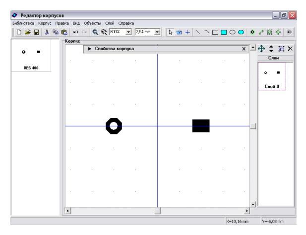
Пожалуйста, задайте следующие свойства для выводов: первый — 2.25x2.25, прямоугольный сквозной, диаметр отверстия 1мм; второй - 2.25x2.25, эллиптический сквозной, диаметр отверстия 1мм.
