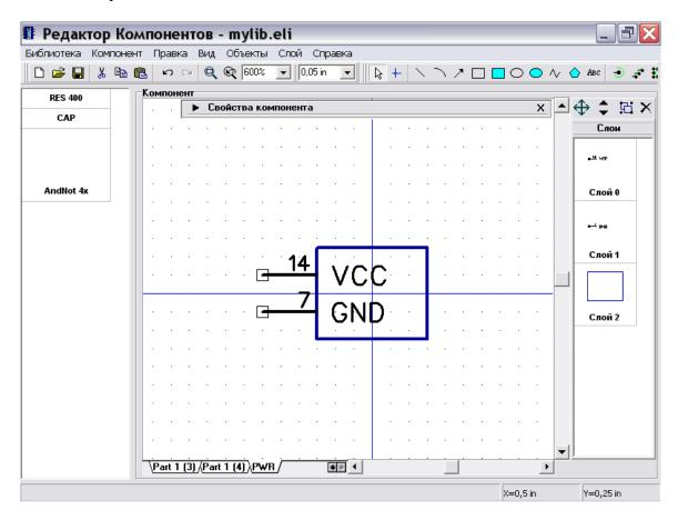
Создадим оставшиеся секции Вашего компонента: выберите одну из секций AN, затем задайте следующие параметры на панели свойсв компонента: тип - "Микросхема", Ширина – "5.08"мм, Между выводами – "2.54"мм, Выводов слева – "2", Выводов справа - "1". Затем минимизируйте панель.
