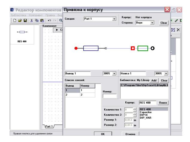
Вы также можете уточнить связь между выводами символа и корпуса используя список связей, этот метод более предпочтителен для средних и больших компонентов. Также номера выводов могут быть заданы с помощью таблицы выводов (выберите "Компонент / Таблица выводов" в главном меню и откройте ее) или из диалога свойств вывода.
