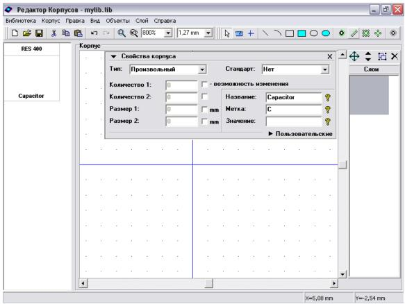
Выберите "Линии" в поле "Тип", затем задайте "1" в поле "Количество 1" (количество линий для данного типа), "2" в "Количество 2" (количество выводов), "10" мм в "Размер 1" (расстояние между выводами). "Размер 2" задает расстояние между линиями, оставьте этот параметр без изменений, т.к. наш корпус содержит выводы на одной линии. Также выставте "возможность изменения" для параметра "Размер 1", это позволит Вам изменять расстояние между выводами без использования Редактора Корпусов.
