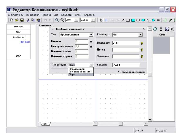
Минимизируйте панель свойсв компонента, затем выберите "Вывод" в правом верхнем углу окна и разместите вывод, поверните его три раза (нажатием клавиш "Ctrl+R"). Затем выберите "Линия" и нарисуйте горизонтальную линию символа.
