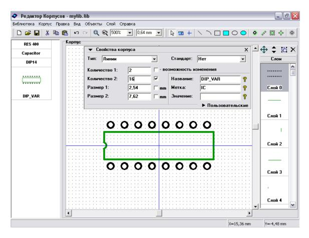
Заметьте, что Вы можете изменить эти параметры в PCB Layout через диалоговое окно свойств корпуса, в Редакторе компонентов и Схемотехнике при привязке к корпусу.
