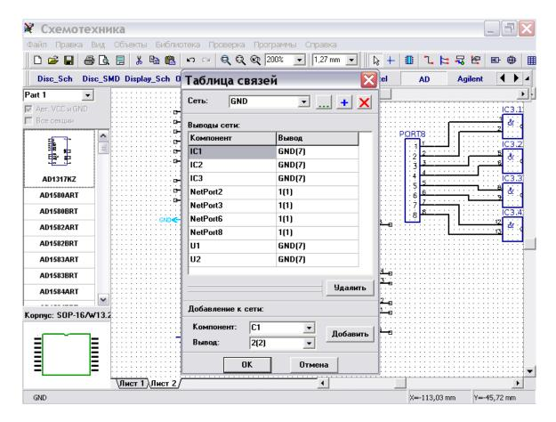
Нажмите "ОК" для принятия изменений и закрытия таблицы связей или "Отмена" для закрытия и возвращения к предыдущей структуре сетей.
