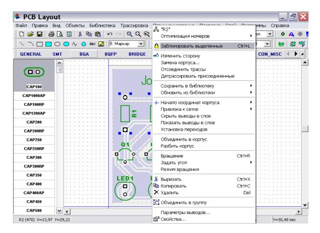
Заметьте, что заблокированные компоненты при выделении имеют менее контрастные прямоугольники вокруг (в нашем случае они имеют такой же цвет, как заливка в нижнем слое, поэтому необходимо отменить заливку, чтобы увидеть прямоугольники). Также для заблокированных объектов вслвающая подсказка содержит текст "Заблокировано".
