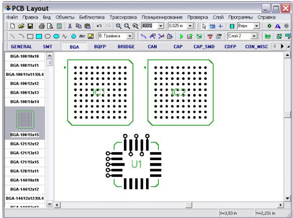
У нас также есть два BGA корпуса. Мы сделаем сквозные переходы для первого корпуса и «глухие» - для второго. Щелкните по первому BGA корпусу и выберите «Установка переходов», выберите Тип корпуса: BGA — Сквозные переходы, установиде диаметр перехода 0,03 in и отверстия 0,15 in, щелкните ОК. Для второго корпуса сделайте все тоже самое, только выберите тип коруса: BGA — Глухие переходы.
