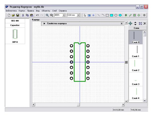
Выберите функцию "Изменить начало координат" и щелкните по первому выводу корпуса "DIP-14" чтобы переместить начало координат в эту точку.
