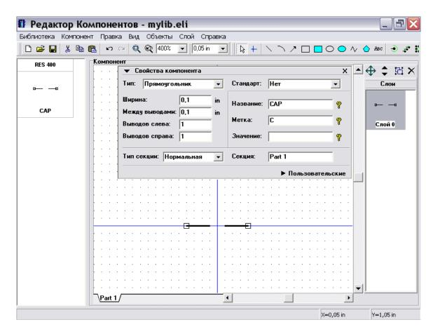
Теперь минимизируйте панель свойств компонента, уменьшите сетку и закончите графику конденсатора, используя три линии и дугу. Для увеличения масштаба нажмите "Ctrl+".
