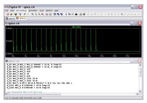
Это зависимость тока через светодиод LED1 от времени. Как видите, период работы автогенератора 20 сек, затем 10 секундный интервал отсутсвия импульсов. Мы также можем посмотреть данные и по другим сетям, диаграммы зависимости напряжения и т.д.
