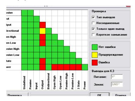
Оставте настройки по умолчанию и нажмите "ОК" или "Отмена" для закрытия диалога. Теперь выберите "Проверка / Проверка связей" в главном меню. Если Вы запустите проверку для Schematic\_2, она покажет одно предупреждение для соединения "Bidirectional to Output". Для локализации ошибки на схеме сделайте двойной щелчок по ней — Вы увидите сеть и выводы, подсвеченные в области построения. Вы можете исправить ошибку и запустить ERC еще раз без выхода из окна результатов проверки.
