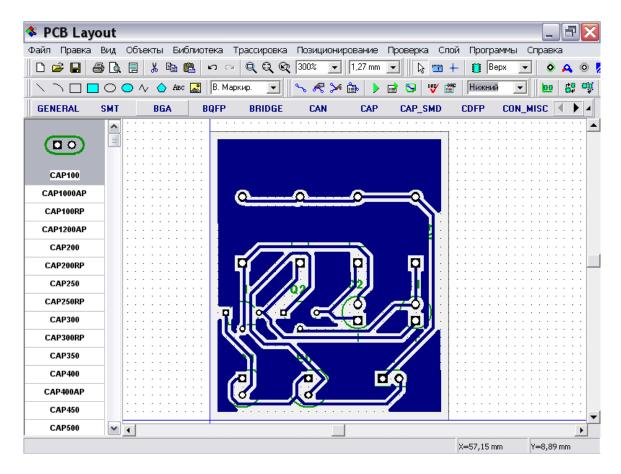
Заливка может иметь два режима: "Заливка" и "Границы". Второй режим лучше, еслы Вы редактируете объекты в слое, в котором есть заливка. Для изменения состояния заливки, свойств и ее обновления сделайте щелчок правой кнопкой на границах и выберите нужный пункт в подменю.
