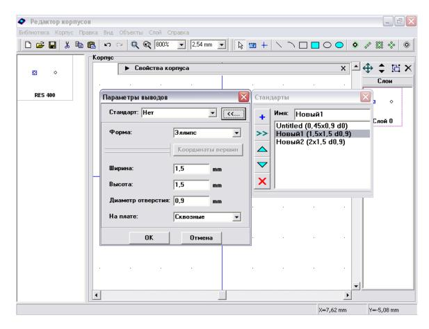
Пожалуйста, закройте "Стандарты", измените форму на "Прямоугольник", ширину на "2мм", на плате "Поверхностные", затем щелкните "ОК" для подтверждения.
