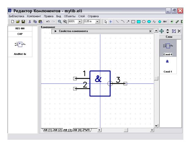
Выберите "Компонент / Таблица выводов" в главном меню. В диалоговом окне таблицы выводов выберите секцию, задайте номера ее выводов, затем выберите следующую секцию и так до тех пор, пока не введете номера выводов для всех секций AN. Закройте таблицу связей.
