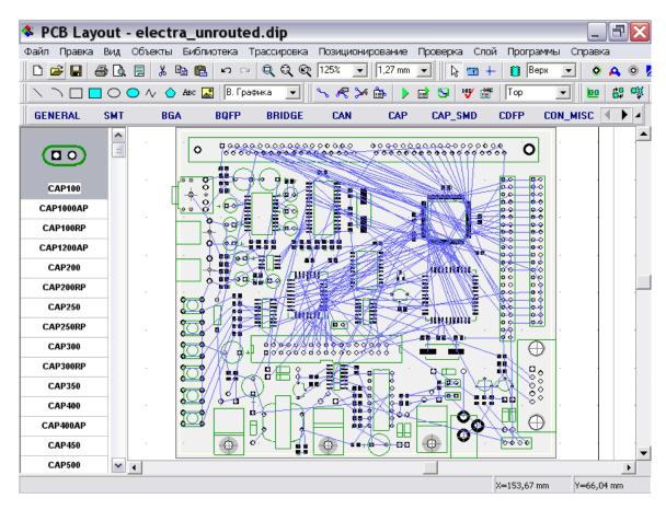
Заметьте, что Вы должны задать ширину трасс и зазоры перед автотрассировкой. Выберите "Трассировка / Параметры трассировки" и измените ширину трасс и зазоров до 0.2 мм. Также Вы можете ввести отдельные настройки для некоторых сетей (например пинания) через их свойства ( щелкните правой кнопкой по выводу, принадлежащему данной сети и выберите Свойства).
