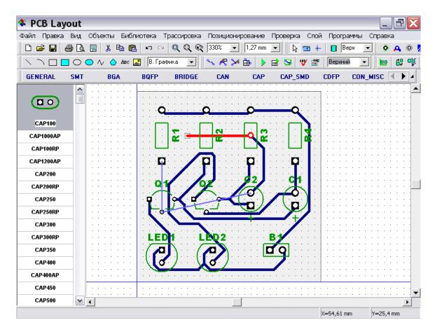
Установите курсор на свободный конец трассы и проведите линию ко второму выводу сети, который еще не соединен (Вы все еще работаете в режиме "Установка трасси". Точору просед соединения со распум руковом.
